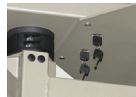
Механическая разблокировка ключом
